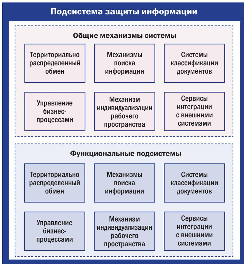
**Рис. 1.** Архитектура системы электронного документооборота.
